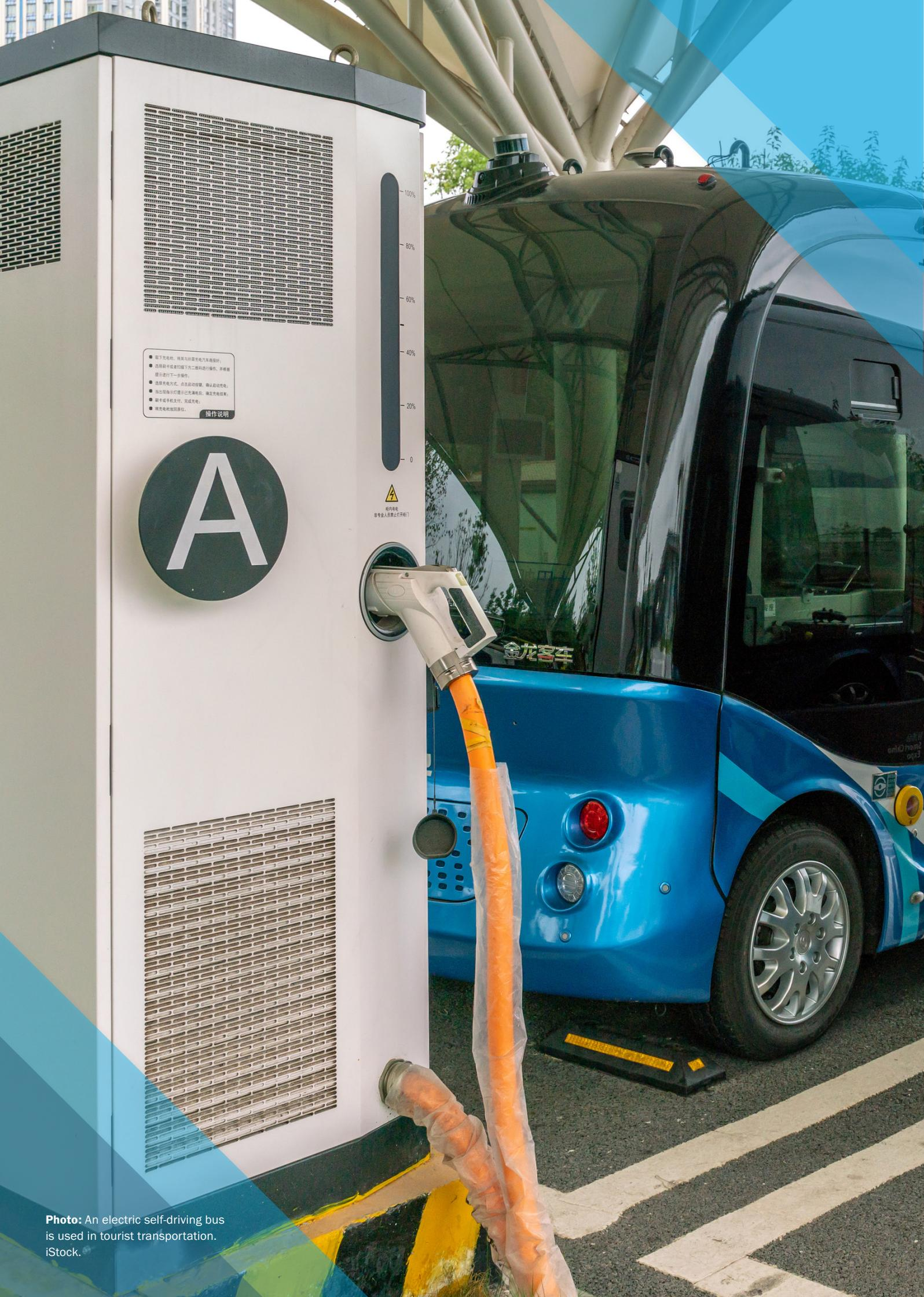
1. 插上充电枪，将充电枪与电动汽车充电接口连接。
